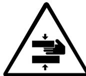
Dieses Symbol signalisiert Quetschgefahr für die Hände beim Eingriff in das laufende Gerät. Mögliche Gefahrenquelle sind bei unsachgemäßem Eingriff die Pneumatikzylinder (CNG/TNG).
