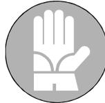
Dieses Symbol weist hin auf die Verletzungsgefahr durch den Umgang mit Stahllinien. Diese stellen aufgrund ihrer Bearbeitungsstellen und Schneiden ein erhöhtes Risiko für Schnitt- und Rißverletzungen an den Händen dar. Durch geeignete Schutzhandschuhe wird dieses Verletzungsrisiko stark gemindert.
