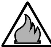
Dieses Symbol signalisiert Brandgefahr. Durch Funkenflug der glühenden Schleifspäne kann entflammbares Material entzündet werden. In der Umgebung der Geräte dürfen keine leicht entflammbaren Materialien (konzentrierter Alkohol, Aceton, Brennstoffe, Holzstaub, ölgetränkte Putzwolle u.ä.) gelagert sein.
