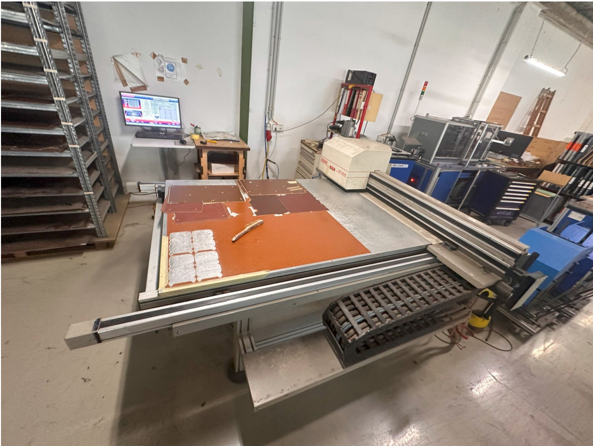
87 1 Fräsmaschine ELCEDE MCS 160-4S, Baujahr 2011, Nr. 043015
